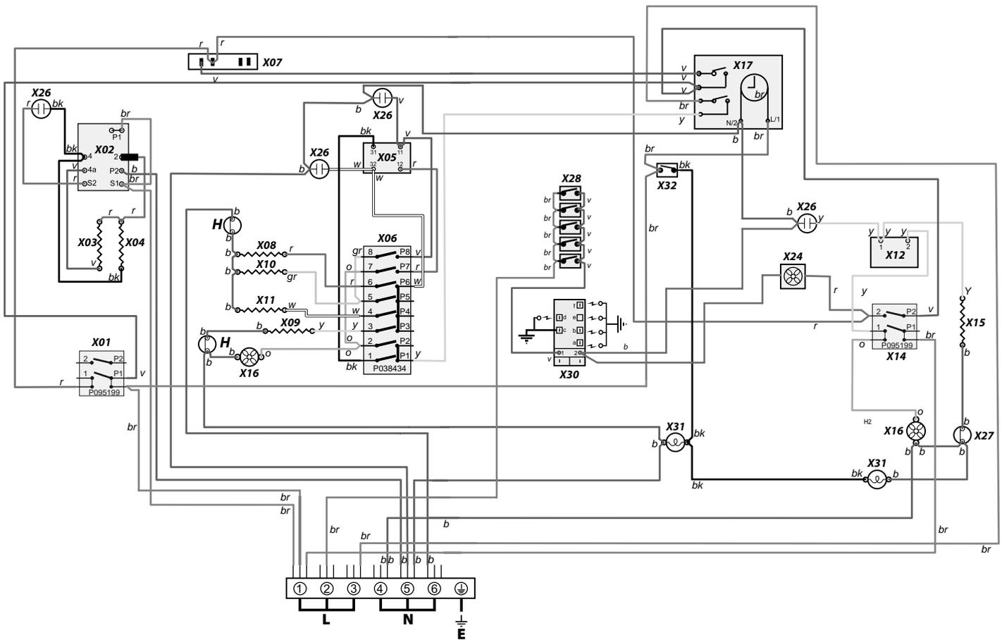
Le raccord indiqué sur le schéma de câblage est pour une alimentation monophasée.
