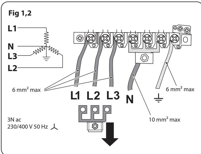
à l'alimentation électrique correcte, indiquée sur l'étiquette de tension sur l'appareil, par le biais d'une unité de commande de cuisinière appropriée à interrupteur bipolaire (avec une séparation de contact de 3 mm au minimum entre les pôles).
