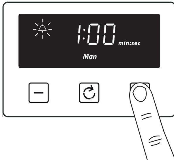
Une fois réglé, le minuteur commencera le compte à rebours par pas de secondes. L'écran affichera le symbole de la minuterie et le temps restant. Le compte à rebours se poursuivra en arrière-plan, si d'autres fonctions sont définies. Une fois le temps réglé pour la minuterie écoulé, une alarme retentit et le symbole de la minuterie clignote à l'écran. Appuyez sur n'importe quel bouton pour arrêter l'alarme et l'heure de la journée s'affiche.
