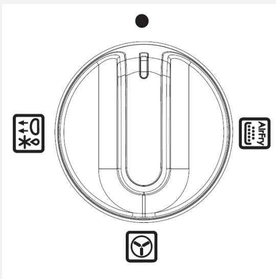
**CONTROL DE TEMPERATURA DEL HORNO PRINCIPAL**
