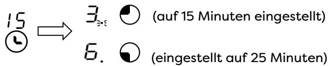
2. Wenn der Countdown-Timer abläuft, schaltet sich die entsprechende Zone aus. Dann wird der neue Min.-Timer angezeigt und der Punkt der entsprechenden Zone blinkt.
