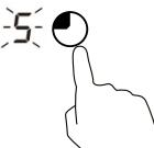
4. Wählen Sie eine Heizstufe, indem Sie den Leistungsregler berühren.
