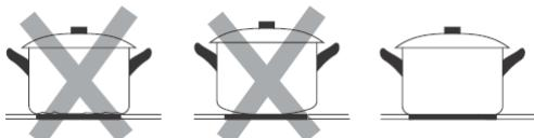
Wenn der Boden des Kochgeschirrs nur teilweise ferromagnetisch ist, erwärmt sich nur der Bereich, der ferromagnetisch ist. Dies kann bedeuten, dass die Wärme nicht gleichmäßig verteilt wird. Der nicht ferromagnetische Bereich erhitzt sich möglicherweise nicht auf eine zum Kochen ausreichende Temperatur.
