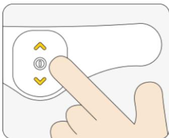
**SCHRITT SIEBEN:** Regulieren Sie die Ausgangsintensität mit den Erhöhen- und Verringern-Tasten.
