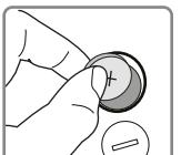
Insérez la pile en placant le + vers le haut. Replacez la porte du compartiment de la pile et verrouillez-la en tournant dans le sens des aiguilles d'une montre à l'aide d'une pièce.
