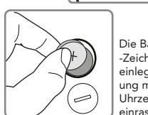
Die Batterie mit dem + -Zeichen nach oben einlegen. Batterieabdeckung mithilfe einer Münze im Uhrzeigersinn drehen und einrasten lassen.
