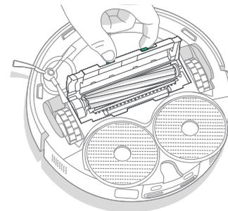
4 Réinstallez la brosse multisurface et le protège-brosse dans le robot.
