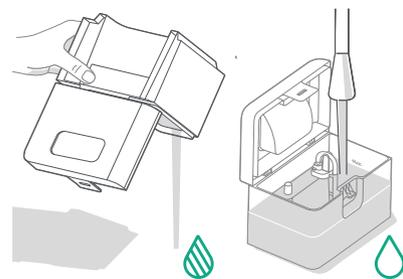
4 Fermez et verrouillez les couvercles des réservoirs d'eau. Remplacez les deux réservoirs dans la base.
