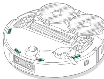
**\* IMPORTANT :** ne pulvérisez pas de solution de nettoyage ni d'eau directement sur les capteurs ou leurs ouvertures.
