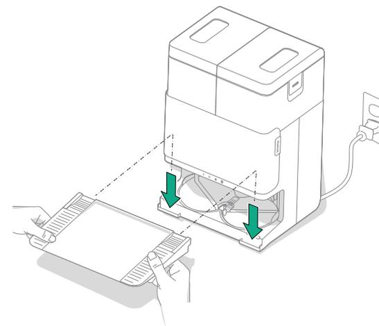
Installez la rampe amovible en l'alignant avec la base. Appuyez dessus pour la bloquer en position.
