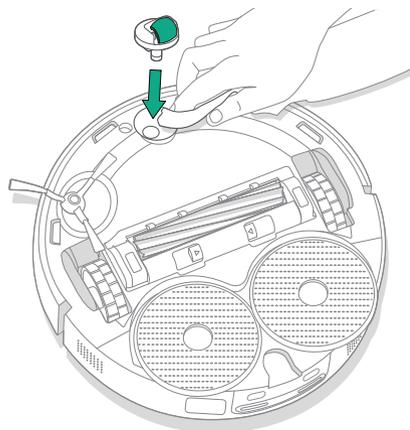
**\* IMPORTANT :** si la roue avant est bloquée par des cheveux, poils ou débris, vous risquez d'endommager le sol. Si la roue ne tourne pas librement une fois que vous l'avez nettoyée, contactez le service client.
