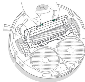
4 Réinstallez la brosse multisurface et le protège-brosse dans le robot.
