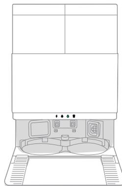
**Blanc fixe** : lorsque le robot est complètement chargé ou en cours de charge. Pendant que la base vide automatiquement le bac, pendant les cycles de lavage ou de séchage et lorsque la base est en mode veille.
