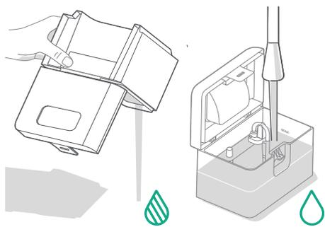
4 Fermez et verrouillez les couvercles des réservoirs d'eau. Remplacez les réservoirs dans la base.
