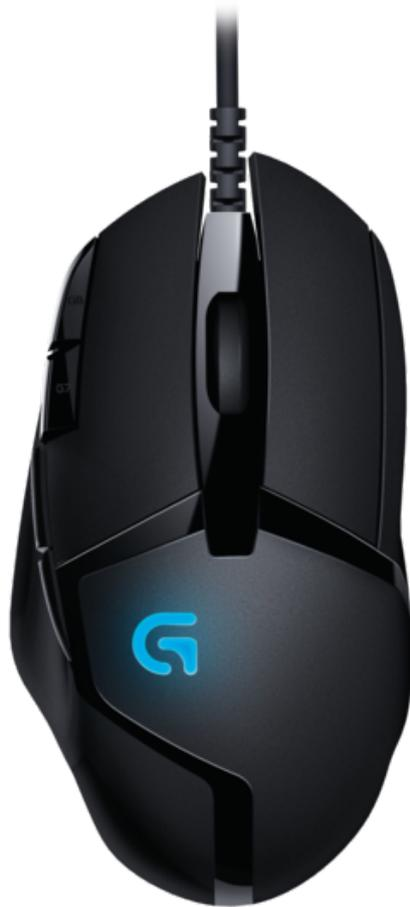
La souris Logitech® G402 Hyperion Fury est la souris pour le jeu la plus rapide au monde, grâce à la technologie de capteur du moteur à fusion qui permet le suivi à une vitesse de plus de 1 m/s. Avec 8 boutons programmables et 4 paramètres de résolution ppp qui peuvent être activés à la volée, la souris Hyperion Fury atteint un nouveau niveau de vitesse et de précision. Arrivez-vous à suivre le mouvement?
