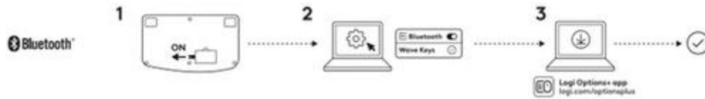
1. Retirez la languette située à l'arrière du clavier. Le clavier sera automatiquement mis sous tension.
