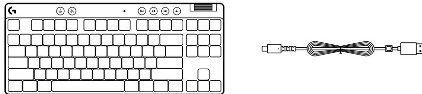
2 将 USB-C 线缆插入键盘正面的端口。
