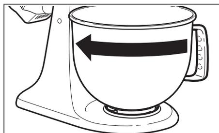
**3** Placez le bol sur la plaque de verrouillage. Tournez délicatement le bol dans le sens des aiguilles d'une montre.
