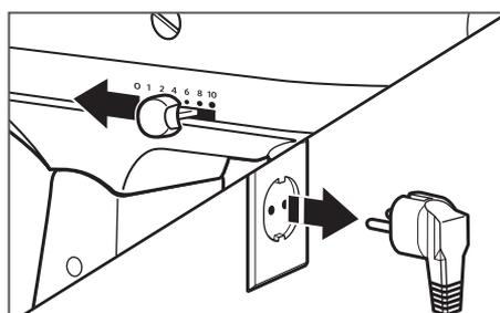
**1** Pour fixer le bol: mettez le levier de contrôle de la vitesse en position « 0 ». Débranchez le robot pâtissier.
