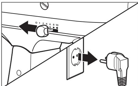
**6** **Démontage** : mettez le levier de contrôle de la vitesse en position « 0 ». Débranchez le robot pâtissier.
