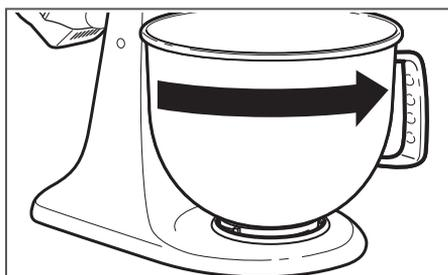
**4** Pour détacher le bol: répétez les étapes 1 et 2. Tournez doucement le bol dans le sens inverse des aiguilles d'une montre.
