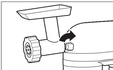
**4** Serrez la vis de fixation des accessoires en la tournant dans le sens des aiguilles d'une montre jusqu'à ce que l'accessoire soit complètement fixé au robot pâtissier.
