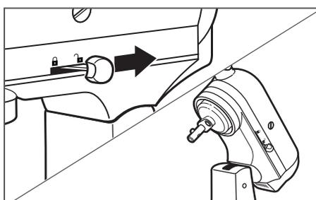
**2** Maintenez le levier de verrouillage en position de déverrouillage et soulevez la tête.
