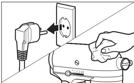
**1** Assurez-vous toujours de débrancher le robot pâtissier avant de le nettoyer. Nettoyez le robot pâtissier à l'aide d'un chiffon humide doux. N'utilisez pas de détergents. Essuyez fréquemment l'axe à accessoire du robot pour enlever tout résidu de nourriture pouvant s'accumuler. N'immergez pas l'appareil dans l'eau.
