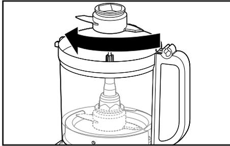
2. Installez le couvercle du bol de travail et assurez-vous que le système de verrouillage du couvercle est en position verrouillée.
