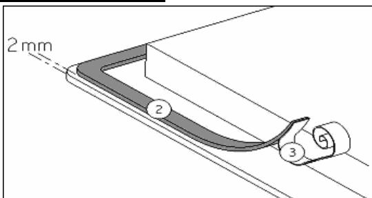
Die Dichtung (2) nach Abnehmen der Schutzfolie (3) mit 2 mm Abstand der Außenkannte des Glases aufkleben.
