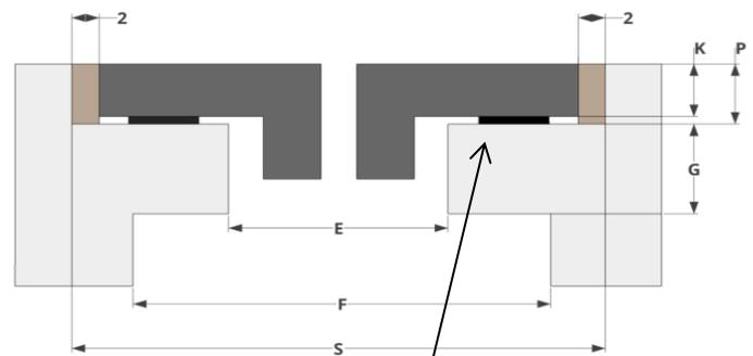
Joint d'étanchéité 2mm
