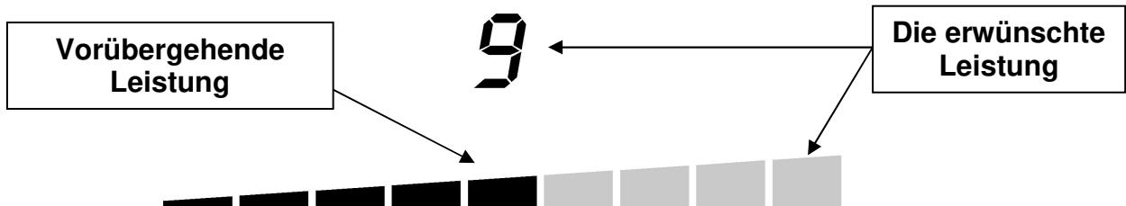
Die Segmente der Anzeige werden nach und nach eingeschaltet, bis die gewünschte Leistung erreicht ist.
