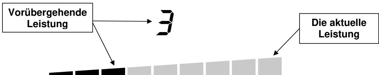
Die Segmente der Anzeige werden nach und nach ausgeschaltet, bis die gewünschte Leistung erreicht ist.
