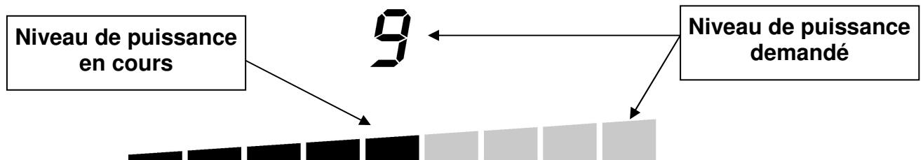
Les segments de l'affichage du niveau de puissance s'allument en surbrillance un par un au fur et à mesure de l'augmentation de la température jusqu'au niveau de puissance demandé.
