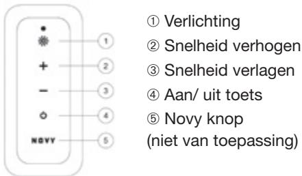
De afstandbediening is voorgeprogrammeerd en werkt direct op het toestel.
