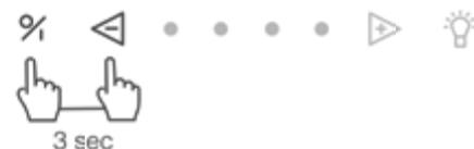
Die Funktion kann eingeschaltet werden, indem Sie die Tasten und 3 Sekunden lang gleichzeitig gedrückt halten. Die zweite und dritte LED blinken 3 Mal zur Bestätigung. (Das Gerät muss ausgeschaltet sein.)
