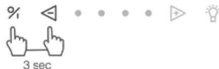
La fonction peut être activée en appuyant simultanément sur les touches **1** et **3** pendant 3 secondes. Les 2ème et 3ème LEDs clignotent 3 fois pour confirmer. (L'appareil doit être éteint).
