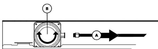
A. Ontkoppel eerst de kabel die naar de te vervangen LED loopt. Het ontkoppelen gebeurt d.m.v.. het lossen van de vergrendeling, door een lichte druk uit te oefenen en tegelijk los te trekken.
