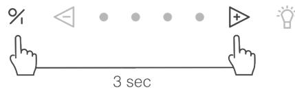
Zum Ausschalten der InTouch-Funktion halten Sie die Tasten **1** und **2** 3 Sekunden lang gleichzeitig gedrückt. Die zweite und vierte LED blitzen 3 Mal zur Bestätigung. (Das Gerät muss ausgeschaltet sein.)
