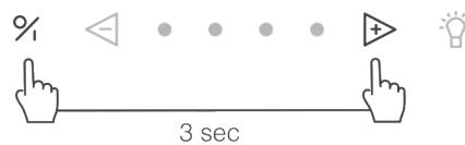
Pour désactiver la fonction InTouch, appuyer simultanément sur les touches ① et ② pendant 3 secondes. Les 2ème et 4ème LEDs clignotent 3 fois pour confirmer. (L'appareil doit être éteint).
