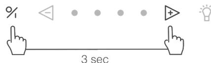
Zum Ausschalten der InTouch-Funktion halten Sie die Tasten ① und ② 3 Sekunden lang gleichzeitig gedrückt. Die zweite und vierte LED blinken 3 Mal zur Bestätigung. (Das Gerät muss ausgeschaltet sein.)
