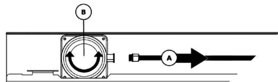
A. Débranchez d'abord le câble qui alimente la LED à remplacer. Pour ce faire, détachez le verrouillage en exerçant une légère pression tout en tirant.
