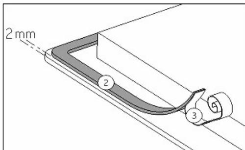
Die Dichtung (2) nach Abnehmen der Schutzfolie (3) mit 2 mm Abstand der Außenkante des Glases aufkleben.
