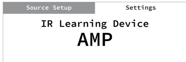
La fonction IR Learning Device permet à toute télécommande de marque autre que NAD d'apprendre les codes de commande de base AMP et BLS (BluOS). Grâce aux codes appris, la télécommande autre que NAD peut alors être utilisée pour commander le C 388.
