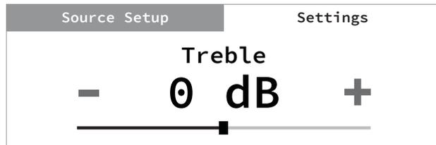
Les commandes des Graves et des Aigus n'affectent que les fréquences graves les plus basses et les fréquences aiguës les plus hautes, de manière à ne pas affecter les fréquences de la plage centrale critique.
