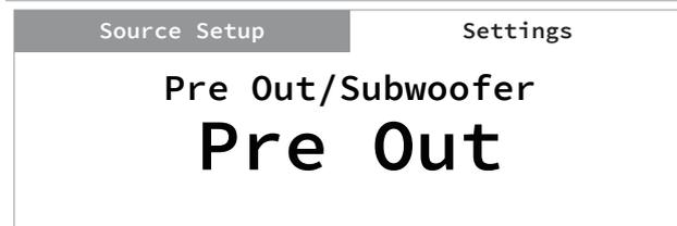
La fonction Pre Out/Subwoofer permet de sélectionner le réglage des bornes PRE-OUT ou SUBWOOFER.
