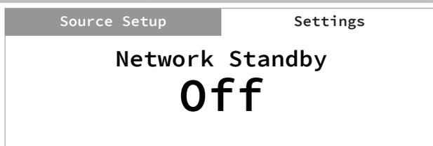
Le mode de connexion en mode de veille maintient la connexion réseau lorsque l'appareil est en veille avec un niveau de performance réduit.
