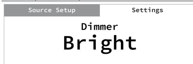
La fonction DIMMER permet d'ajuster la luminosité de l'affichage du panneau avant.
