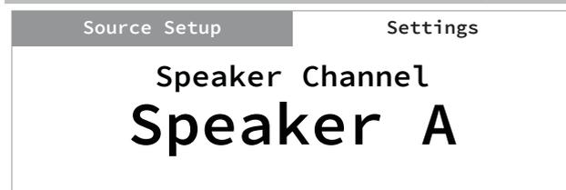
SPEAKER CHANNEL vous permet d'activer ou de désactiver les haut-parleurs connectés respectivement aux bornes SPEAKERS A et SPEAKERS B du panneau arrière.
