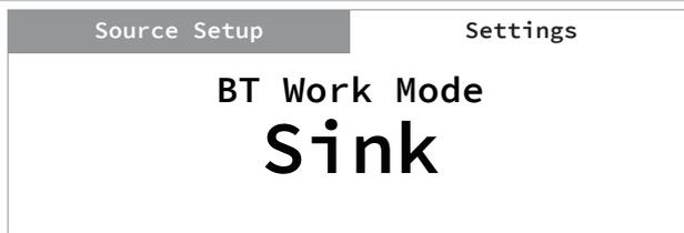
La fonction BT (Bluetooth) Work Mode définit les deux rôles de C 388 soit un récepteur (sink) ou une source Bluetooth.
