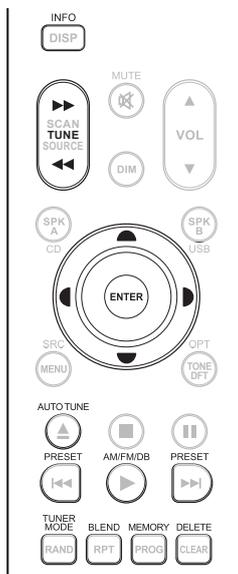
**COMMANDE DE TUNER (à utiliser avec un AM/FM/DAB Tuner NAD) :** Appuyez sur la touche « TUN » de la partie DEVICE SELECTOR (Sélecteur de périphérique) pour accéder à ces touches.
