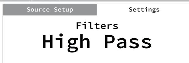
Les filtres offrent la biamplification ou l'intégration du caisson de graves simples en ajoutant les filtres requis pour rediriger les basses fréquences au caisson de graves.
