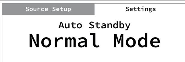
La fonction de mise en veille automatique est une caractéristique intégrale du C 388 conforme aux règlements écodesign européens. Le C 388 peut être réglé pour passer automatiquement au mode de veille s'il n'y a pas d'interaction de l'interface d'utilisateur et qu'aucune source n'est active pendant 20 minutes.
