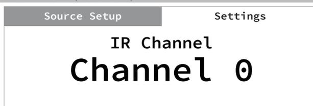
Le C 388 peut fonctionner sur un canal IR substitut. C'est particulièrement utile si vous avez deux produits NAD qui peuvent être opérés par des commandes de télécommande similaires. Grâce au canal IR substitut, deux produits NAD différents peuvent être commandés indépendamment dans la même zone en les réglant sur des canaux IR différents.
