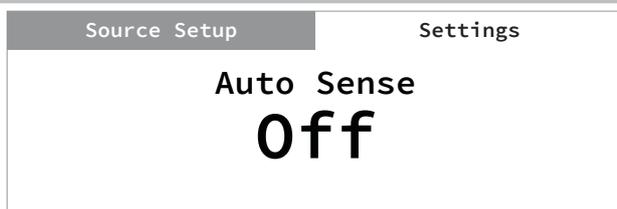
La fonction Auto Sense permet le réveil automatique du C 388 dès qu'il est déclenché par une appli du réseau ou une source branchée active.
