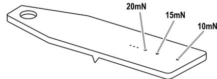
5 Réglez la quantité de pression en déplaçant délicatement le contrepois (11) le long de la tige de support jusqu'à ce que la pression soit suffisante pour lever la jauge à l'horizontale. Éloigner le contrepois (11) de la cellule réduit la pression, alors que le rapprocher augmente la pression.
