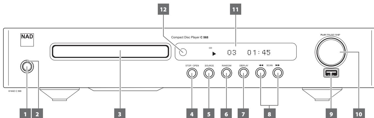
**1 BOUTON STANDBY (VEILLE) :** appuyez sur ce bouton pour allumer le C 568. Le voyant à LED Standby (Veille) passe de la couleur jaune à la couleur bleue, et l'affichage fluorescent à vide (VFD) s'allume. Une nouvelle pression sur ce bouton fait repasser l'appareil en mode Standby (Veille).
