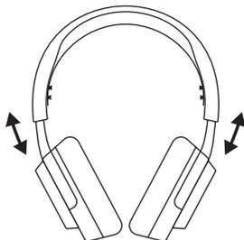
Modifiez la position du **Bandeau élastique\* (8)** d'un ou des deux côtés pour obtenir la tension et la souplesse souhaitées.
