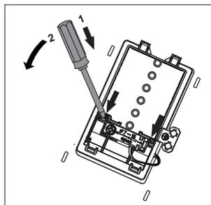
N'oubliez pas que le fil de connexion doit correspondre au type de connexion et à la puissance nominale de la cuisinière. Ne traitez pas les extrémités du câble par soudure. La gaine de câble doit être montée dans le dispositif de décharge de traction, qui est adapté aux câbles d'un diamètre de 7 à 15 mm.
