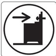
**MISE EN GARDE:** Pour éviter le risque de basculement de l'appareil, le dispositif de stabilisation par les fixations anti-basculement doit être mis en place.
