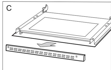
3. Débranchez la vitre intérieure de sa fixation (en partie inférieure de la porte). Extraire la vitre intérieure. (fig. D1).
