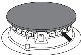
Note: Tous les éléments du brûleur doivent toujours rester secs. Les particules d'eau peuvent diminuer le débit de gaz et provoquer une mauvaise combustion.
