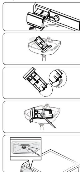
1. Tout en maintenant le levier de dégagement situé à l'intérieur du compartiment, faites glisser le tiroir pour l'ouvrir et retirez-le de la machine.
