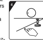
Pressez manuellement la bande à double face sur quatre côtés pour fixer fermement la plaque antibruit sur le corps de la machine.
