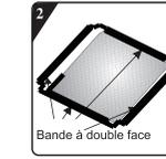
Retirez le papier de surface sur la bande à double face à quatre côtés de la plaque inférieure.
