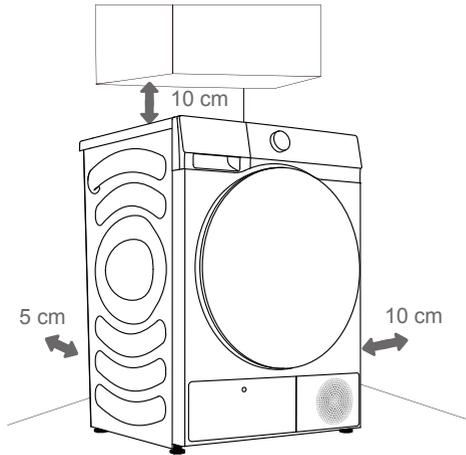
☞ Le sèche-linge ne doit pas être en contact avec un mur ou un meuble adjacent. Pour un fonctionnement optimal de l'appareil, laissez un espace autour de l'appareil comme indiqué sur la figure. Le non-respect des espaces minimum requis peut entraîner une surchauffe.
