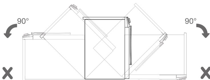
⚡ Après l'installation, attendez 24 heures sans déplacer l'appareil avant de l'utiliser pour la première fois. Si le sèche-linge doit être couché sur l'un des côtés pendant le transport ou l'entretien, placez-le avec son côté gauche, vu de l'avant de l'appareil, vers le bas.
