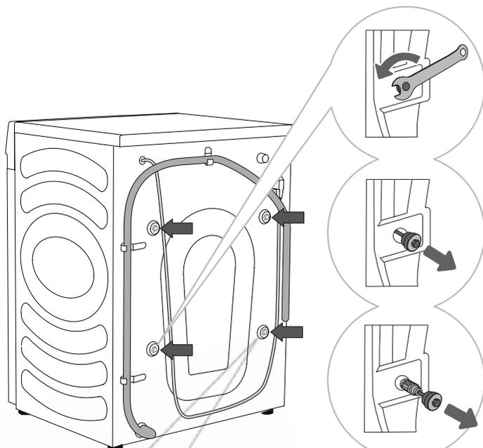
**1** Mettez de côté les tuyaux et utilisez une clé à molette pour desserrer les 4 vis situées à l'arrière de l'appareil en les tournant dans le sens antihoraire, comme indiqué par la flèche. Desserrez-les d'environ 30 mm (pas complètement).
