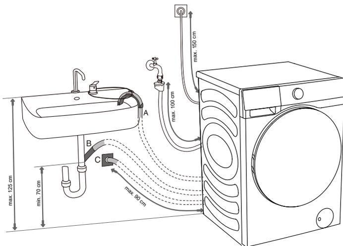
**A** L'extrémité du tuyau d'évacuation peut être placée au-dessus d'un lavabo ou d'une baignoire. Utilisez un collier de serrage pour fixer le tuyau sur le support coudé afin d'éviter qu'il ne glisse.
