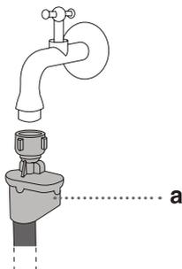
⚠ Ne plongez pas le tuyau d'eau équipé du système AquaStop, dans l'eau, car il contient une soupape électrique.
