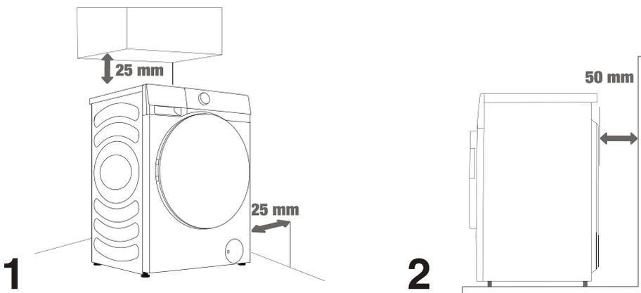
💡 La machine ne doit pas être en contact avec un mur ou un meuble. Pour un fonctionnement optimal de la machine, laissez de l'espace autour de la machine, comme indiqué sur la figure. Le non-respect des distances minimales requises peut entraîner un fonctionnement dangereux ou anormal de la machine. De plus, une surchauffe peut également se produire (figures 1 et 2).
