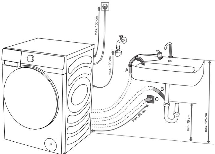
**C** Le tuyau d'évacuation peut également être fixé à un siphon mural, qui doit être correctement installé pour permettre le nettoyage.
