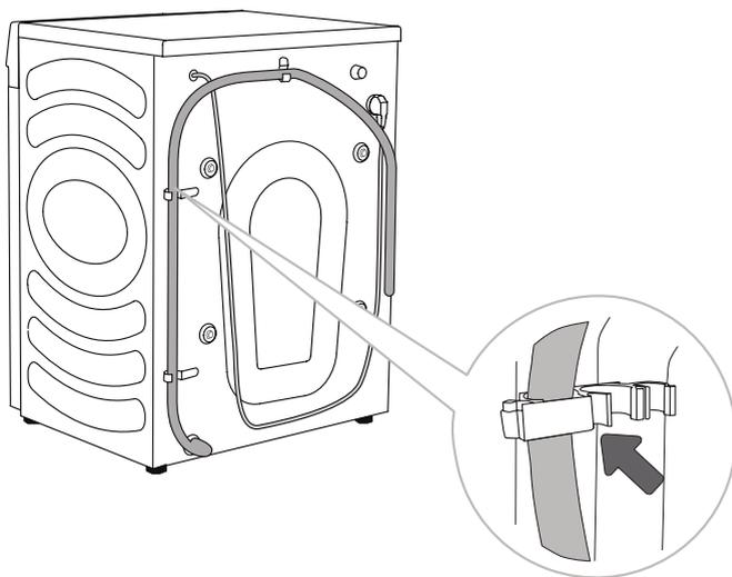
**D** Le tuyau d'évacuation doit être fixé aux crochets situés au dos de la machine, comme indiqué sur la figure.
