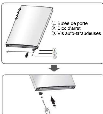
6. Utilisez la clé Allen (fournie dans le sac en plastique) pour desserrer les vis utilisées à fixer la charnière centrale droite et retirer la charnière centrale droite. Ensuite, retirez la porte inférieure.
