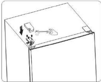
16. Retirez la porte supérieure et placez-la sur une surface molle, le panneau avant vers vous. Soulevez l'élément ① et l'élément ④, puis desserrez les vis ②, comme cela est montré sur l'illustration. Déplacez la poignée ③ vers le côté droit, puis installez les éléments ②, ① et ④, les uns après les autres.
