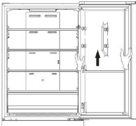
5. Placez la porte supérieure sur une surface lisse avec son panneau vers le haut. Desserrez la vis ③ et retirez les pièces ② et ①, installez la butée de porte de remplacement à gauche fournie (dans le sac en plastique attaché) et le bloc d'arrêt gauche sur le côté gauche à l'aide de la vis ③. Conservez la pièce ① et ② avec l'appareil pour référence ultérieure.
