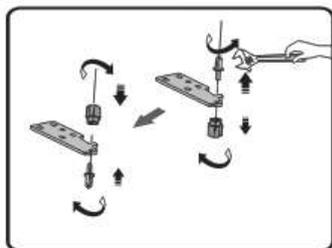
10. Redressez le réfrigérateur et insérez soigneusement la porte inférieure dans la goupille de la charnière inférieure et maintenez-la en place. Installez la charnière centrale gauche (dans le sac
