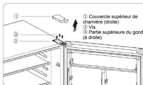
3. Retirez le couvercle de la vis du coin avant gauche du compartiment à l'aide d'un tournevis à lame fine et installez-le dans le coin avant droit. Mettez le couvercle de la charnière supérieure (droite) et la pièce de la charnière
