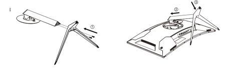
b. Inclinez la base dans le sens de la deuxième flèche et fixez-la avec quatre vis M4\*16
