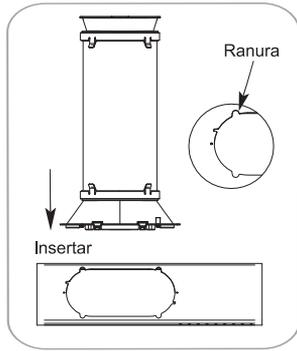
Alinee las lengüetas en el adaptador de escape de la ventana con las ranuras en el panel de ventilación. Coloque el adaptador de escape de la ventana en la abertura del panel de ventilación.
