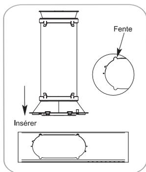
Aligner les languettes de l'adaptateur d'évacuation pour fenêtre avec les encoches du panneau d'évacuation. Insérer l'adaptateur d'évacuation pour fenêtre dans l'ouverture du panneau d'évacuation.
