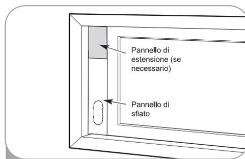
Inserire il gruppo del pannello di sfiato, compresi i pannelli di estensione, se necessario, nell'apertura della finestra. Estendere i pannelli di estensione, se utilizzati.
