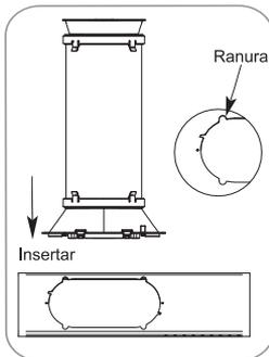
Alinee las lengüetas en el adaptador de escape de la ventana con las ranuras en el panel de ventilación.
