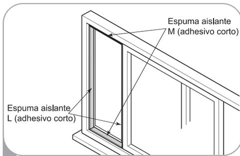
Corte la espuma aislante L (adhesivo) y M (adhesivo corto) a la longitud correcta y añádala al marco y guillotina de la ventana.
