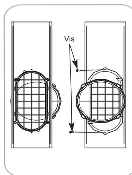
Insérez la vis dans le trou de l'adaptateur de vidange de la fenêtre pour éviter que l'adaptateur de drain de la fenêtre ne glisse hors de l'ouverture de ventilation.
