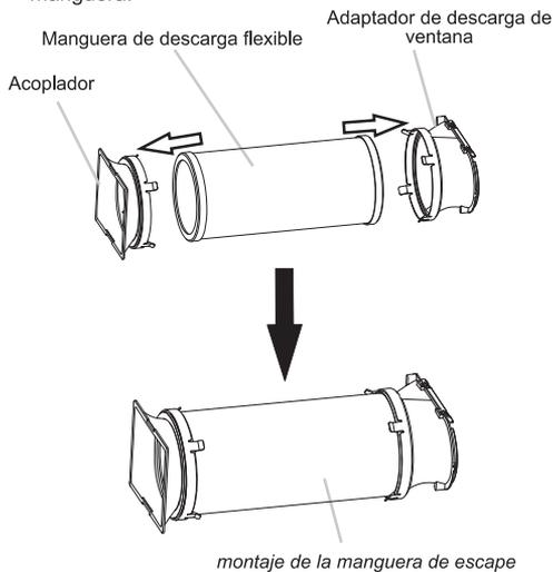
3. Coloque el acople en la ranura de la parte trasera del aire acondicionado.
