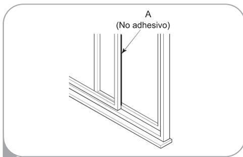
Corte la espuma aislante A (del tipo no adhesivo) al ancho de la ventana. Rellene con el sello aislante A entre el vidrio y la ventana para evitar que el aire y los objetos extraños ingresen.
