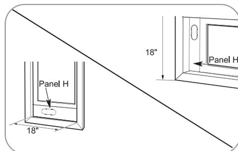
Para una ventana con una abertura de 18", utilice un panel de ventilación.
