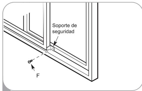
En caso de ser necesario, instale el bloqueo de la ventana con el tornillo F como se muestra aquí.
