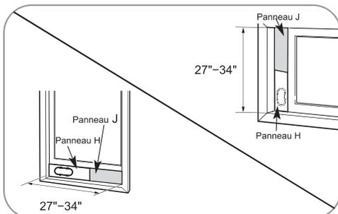
Pour des ouvertures de fenêtre de 27" à 34", utiliser le panneau d'évacuation pour fenêtre (Panneau H) et un panneau d'extension (Panneau J).
