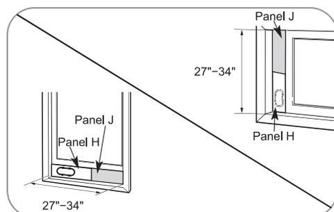
Para ventanas con aberturas desde 27" a 34", utilice el panel de ventilación (Panel H) y un panel de extensión (Panel J).
