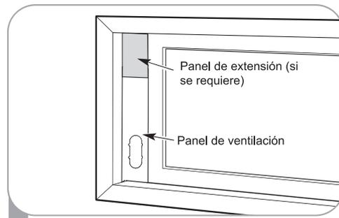
Inserte el montaje del panel de ventilación, incluyendo los paneles de extensión, si es necesario, en la abertura de la ventana. Extienda los paneles de extensión, si se utilizaron.
