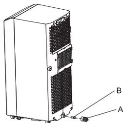
A. Tapa primaria del desagüe B. Tapón primario del desagüe
