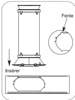
Aligner les languettes de l'adaptateur d'évacuation pour fenêtre avec les encoches du panneau d'évacuation.
