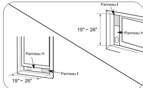
Pour des ouvertures de fenêtre de 19" à 26", utiliser le panneau d'évacuation pour fenêtre (Panneau H) et un panneau d'extension (Panneau I).
