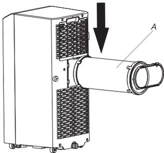
A. Montage du tube flexible d'évacuation
