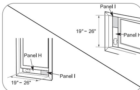
Para ventanas con aberturas desde 19" a 26", utilice el panel de ventilación (Panel H) y un panel de extensión (Panel I).
