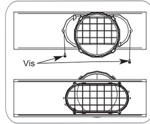
Insérez la vis dans le trou de l'adaptateur de vidange de la fenêtre pour éviter que l'adaptateur de drain de la fenêtre ne glisse hors de l'ouverture de ventilation
