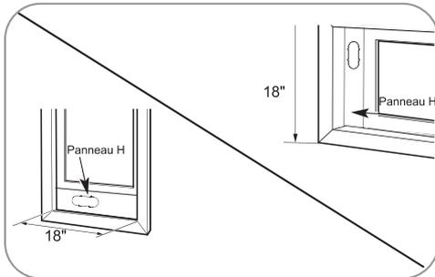
Pour une fenêtre de 18", utilisez uniquement le panneau de ventilation de la fenêtre.
