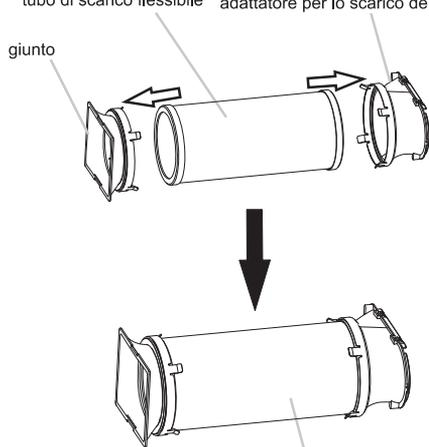
montaggio del tubo di scarico
