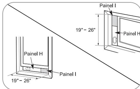
Para janelas com aberturas de 19" a 26", use o painel de ventilação (Panel H) e um painel de extensão (Panel I).
