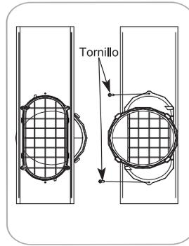
Inserte el tornillo en el orificio del adaptador de escape de la ventana para evitar que el mismo se deslice fuera de la abertura de ventilación.
