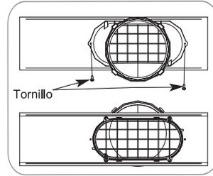
Inserte el tornillo en el orificio del adaptador de escape de la ventana para evitar que el mismo se deslice fuera de la abertura de ventilación
