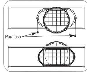
Prenda um parafuso no orifício do adaptador do exaustor de janela para evitar que o adaptador deslize e saia da abertura de ventilação
