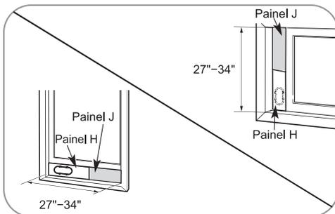
Para janelas com aberturas de 27" a 34", use o painel de ventilação (Panel H) e um painel de extensão (Panel J).
