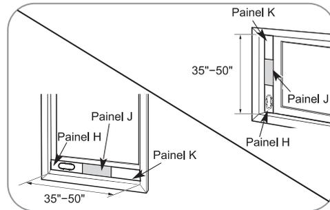
Para janelas com aberturas de 35" a 50", use o painel de ventilação e dois painéis de extensão (Panel K e Panel J).
