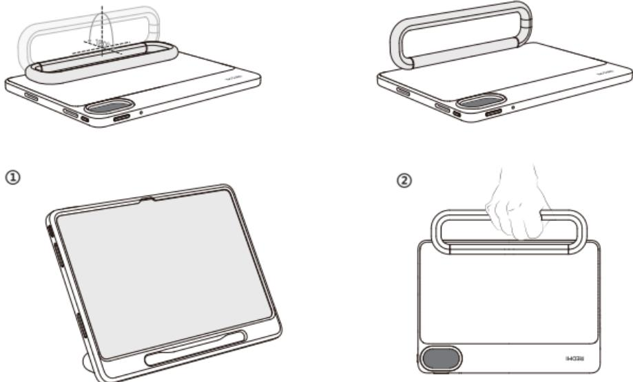
\*Gire el anillo del soporte 180° para colgarlo o transportarlo. Evite balancear excesivamente el dispositivo cuando lo transporte con la mano para evitar daños mecánicos.
