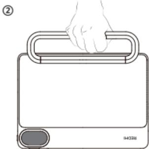
\*Ruotare l'anello di supporto di 180° per appendere o trasportare il dispositivo.
