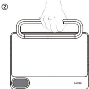
\*Drehen Sie den Stützring um 180° zum Aufhängen oder Tragen. Vermeiden Sie übermäßiges Schwingen beim Tragen des Geräts in der Hand, um mechanische Schäden zu vermeiden.
