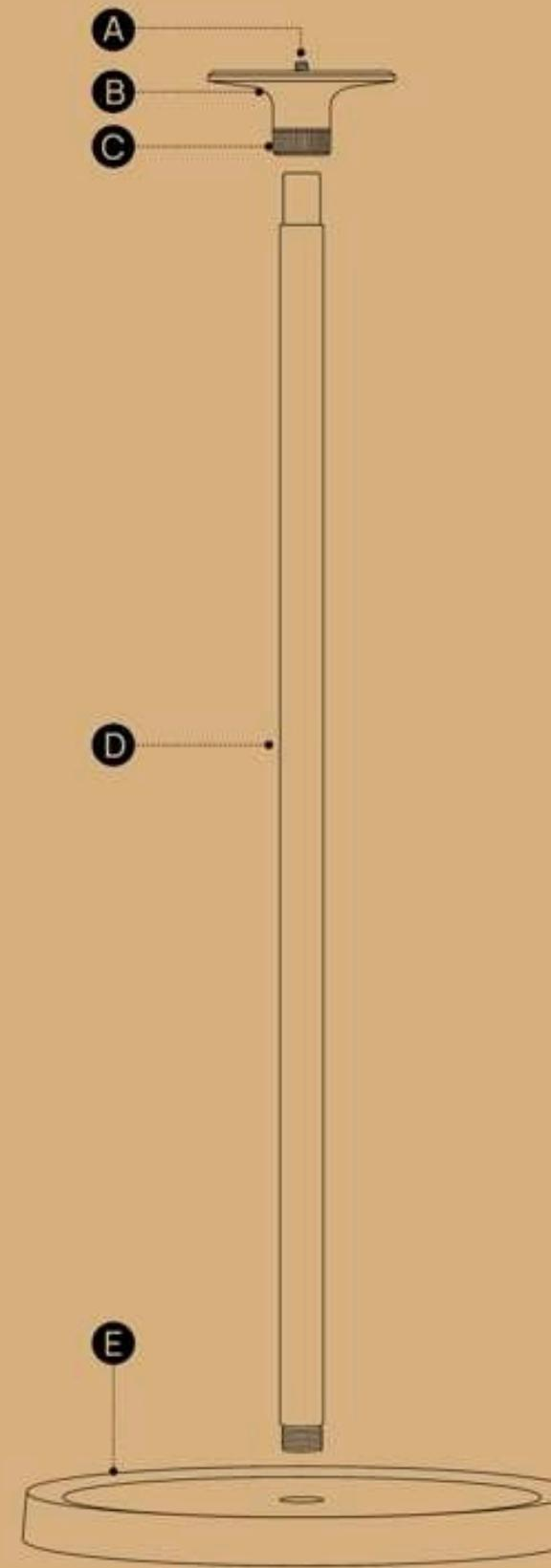
1 Placez la base à l'endroit souhaité, alignez l'extrémité filetée de la tige de support avec le centre de la base et vissez la tige dans le sens horaire.
