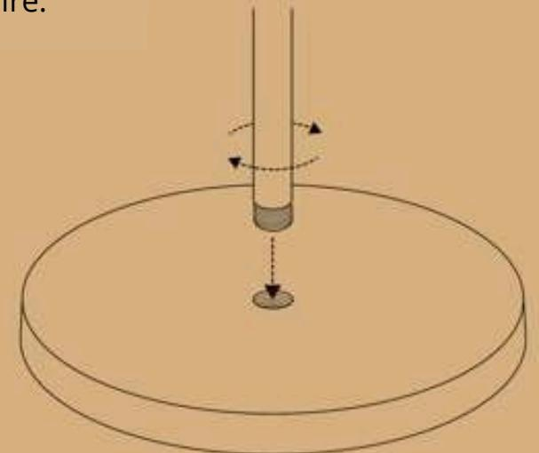
2 Alignez le trou fileté situé sous le projecteur avec l'écrou 1/4 pouce du support de projecteur et serrez le support de projecteur dans le sens antihoraire pour le fixer au projecteur.
