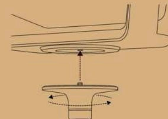
3 Placez le support de projecteur, avec le projecteur fixé, sur le dessus de la tige de support, puis serrez la molette dans le sens horaire pour terminer l'assemblage.
