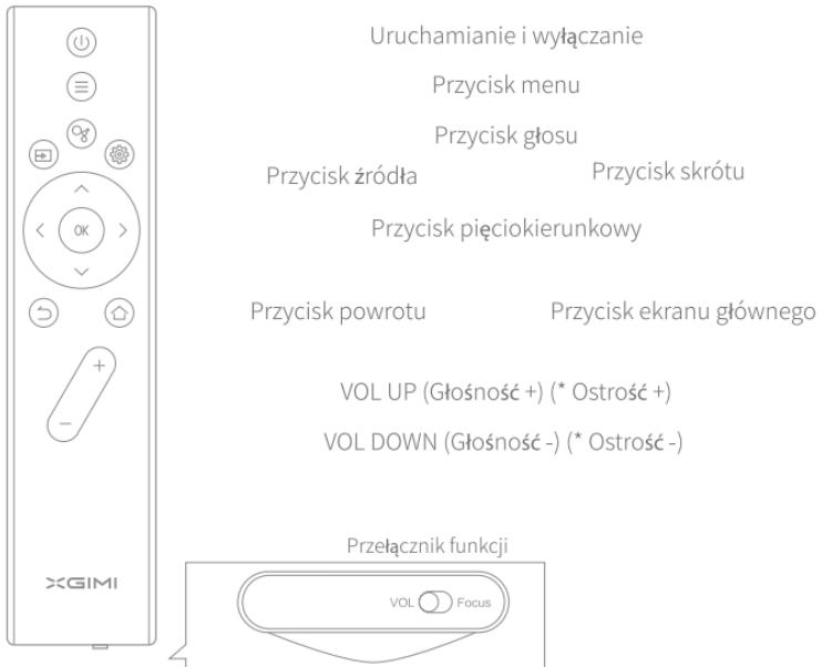
\* Głośność jest regulowana za pomocą przycisku zwiększenia lub zmniejszania, gdy przełącznik funkcji jest przesunięty w lewo (Głośność);
