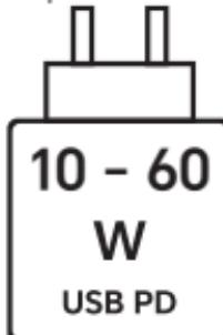
Puterea furnizată de încărcător trebuie să fie între min. 10 W, ceruți de echipamentul radio, și max. 60 W, pentru a atinge viteza maximă de încărcare. Încărcare rapidă USB PD.
