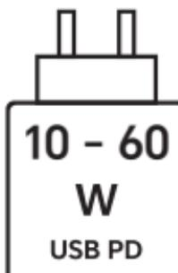
Effekten som leveres av laderen må være mellom minimum 10 Watt som påkrevd av radioutstyret og maksimum 60 Watt for å oppnå maksimal ladehastighet. USB PD-hurtiglading.
