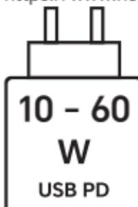
Strömmen som levereras av laddaren måste vara minst 10 watt för radioutrustningen, och högst 60 watt för att uppnå maximal laddningshastighet. USB PD-snabbladdning.
