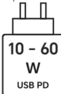
Зарядний пристрій має надавати потужність у діапазоні від мінімального значення 10 Вт, потрібного для роботи радіообладнання, до максимального значення 60 Вт, потрібного для максимально швидкого заряджання. Швидке заряджання виконується на основі технології USB PD.
