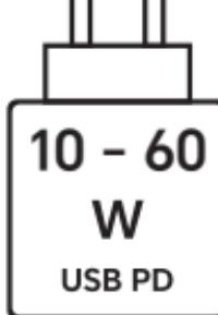
Výkon dodávaný nabíječkou musí být v rozsahu od 10 W požadovanými rádiovými zařízeními do 60 W potřebnými k dosažení maximální rychlosti nabíjení. Rychlé dobíjení USB PD.
