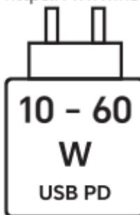
Het door de oplader geleverde vermogen moet tussen 10 watt minimum liggen die de radioapparatuur nodig heeft en 60 watt maximum om de maximale laadsnelheid te bereiken. USB PD snel laden.
