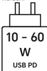
Die vom Ladegerät bereitgestellte Leistung muss zwischen dem vom Funkgerät benötigten Mindestwert von 10 Watt und dem Höchstwert von 60 Watt liegen, um die maximale Ladegeschwindigkeit zu erzielen. USB-PD-Schnellladung.
