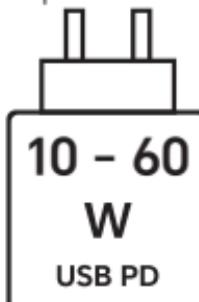
Laadija poolt edastatav võimsus peab olema vahemikus min 10 W, mida vajavad raadioseadmed, kuni max 60 W, et saavutada maksimaalne laadimiskiirus. USB PD kiirlaadimine.
