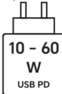
За да се постигне максимална скорост на зареждане, мощността, осигурявана от зарядното устройство, трябва да бъде между минимум 10 вата, изисквани от радиооборудването, и максимум 60 вата. Бързо зареждане с USB PD.
