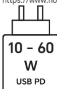
Moc dostarczana przez ładowarkę musi wynosić między minimalnie 10W wymaganych przez urządzenie radiowe a maksymalnie 60W, aby osiągnąć maksymalną prędkość ładowania. Szybkie ładowanie USB PD.
