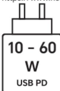
Výkon nabíjačky musí byť medzi min. hodnotou 10 wattov, ktorú vyžadujú vysielacie časti zariadenia, a max. hodnotou 60 wattov, aby sa dosiahla maximálna rýchlosť nabíjania. Rýchle nabíjanie pomocou USB PD.
