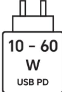
La puissance délivrée par le chargeur doit être comprise entre les 10 watts minimum requis par l'équipement radio et 60 watts maximum afin d'atteindre la vitesse de charge maximale. Charge rapide USB PD.
