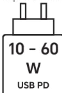
La potenza erogata dal caricabatterie deve essere compresa tra min 10 Watt, come richiesto dall'apparecchiatura radio, e max 60 Watt per ottenere la massima velocità di ricarica. Carica rapida USB PD.
