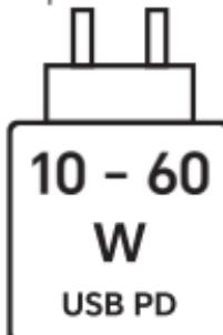
La potencia que suministra el cargador debe estar entre un mínimo de 10 vatios requeridos por el equipo de radio y un máximo de 60 vatios para alcanzar la máxima velocidad de carga. Carga rápida de suministro de energía por USB.
