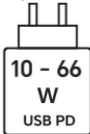
La potenza erogata dal caricabatterie deve essere compresa tra min 10 Watt, come richiesto dall'apparecchiatura radio, e max 66 Watt per ottenere la massima velocità di ricarica. Carica rapida USB PD.
