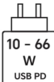
La puissance délivrée par le chargeur doit être comprise entre les 10 watts minimum requis par l'équipement radio et 66 watts maximum afin d'atteindre la vitesse de charge maximale. Charge rapide USB PD.
