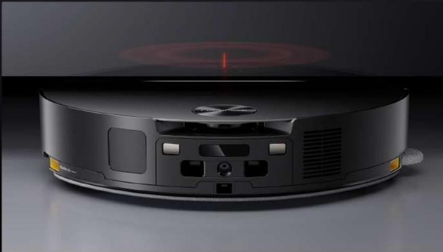
Le télémètre orienté vers le haut mesure précisément la hauteur de la zone, permettant au LDS de s'abaisser au moment approprié pour passer dans les zones à faible dégagement et de se lever rapidement une fois sorti de la zone, ce qui garantit une cartographie fluide sans délai ni perte de carte.
