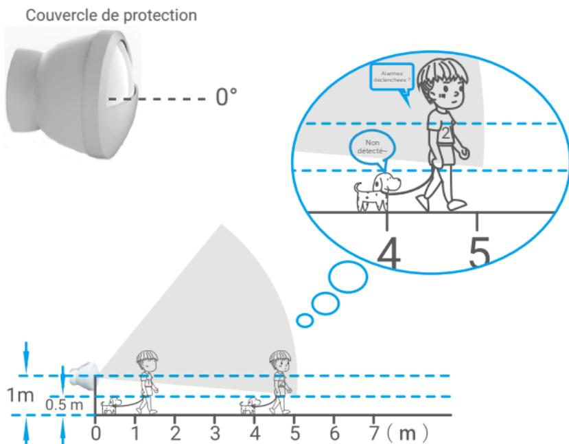
Fig. 1 – Vue latérale de la plage de détection
