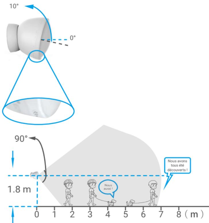
Fig. 1 – Vue latérale de la plage de détection
