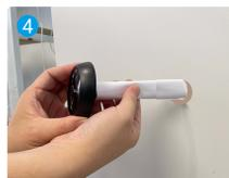
Passez les vis et le câble à travers la porte. Enroulez le câble dans du papier pour faciliter l'opération.
