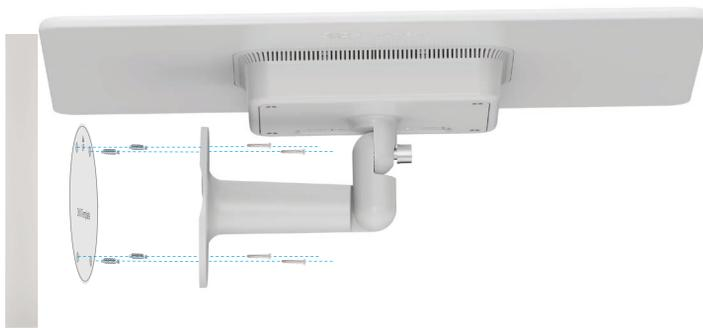
**i** Lors du perçage de trous pour les boulons d'expansion, veuillez vous assurer que le diamètre de la tête de perçage est de 7 mm et que la profondeur du trou n'est pas inférieure à 35 mm.
