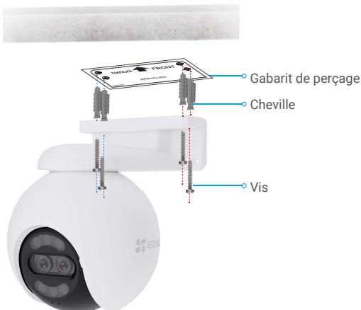
Fig. 1 Montage au plafond
