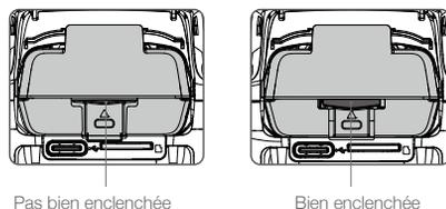
Appuyez sur la bride de la batterie et détachez la batterie du compartiment pour la retirer.
