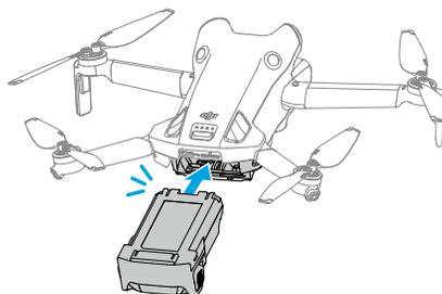
Appuyez sur la partie texturée des glissières sur les côtés de la batterie pour la retirer du compartiment.
