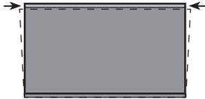
Si le haut de l'image est plus étroit que l'écran, utilisez la clé pour faire pivoter les pieds gauche et droit du Cinéma Laser dans le sens des aiguilles d'une montre jusqu'à ce que les bords gauche et droit de l'image soient parallèles aux bordures de l'écran.
