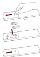
1. Faites coulisser le couvercle arrière pour ouvrir le compartiment des piles de la télécommande.
