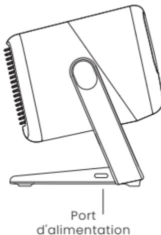
Mise sous/hors tension: le bouton d'alimentation est un bouton physique, appuyez brièvement pour allumer ou éteindre l'appareil.
