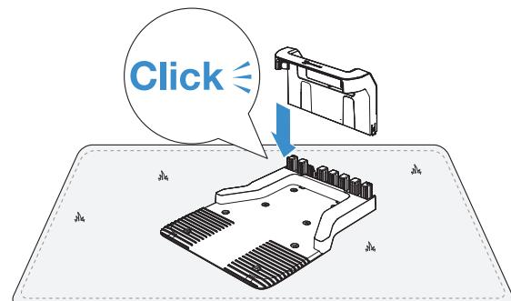
5. Befestigen Sie die Station am Boden im ausgewählten Bereich mit Bodenankern mit dem Innensechskantschlüssel
