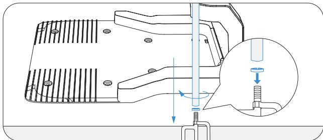
3. Bringen Sie den Signalkopf an. Setzen Sie zu diesem Zweck dessen erhöhten Teil in die Montagestange ein und ziehen Sie die Schrauben mit einem Werkzeug fest.
