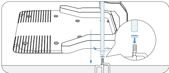
3. Fissare la testina di segnalazione inserendo la parte rialzata nel paletto di montaggio e serrando le viti con un utensile.
