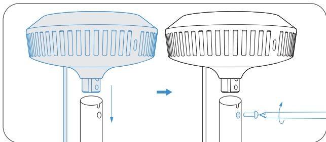
4. Collegare il cavo di alimentazione dell'RTK al cavo di alimentazione della stazione base e serrare il dado.
