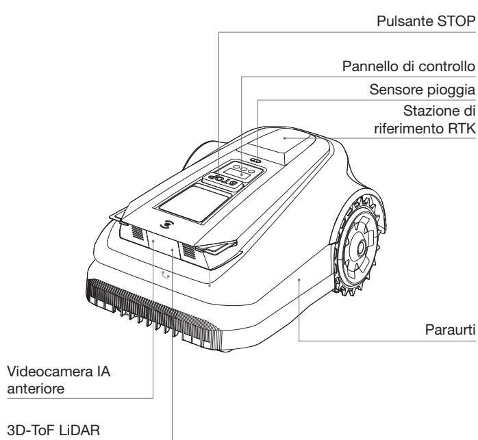
**Pannello di controllo:** I pulsanti del pannello di controllo consentono le operazioni di base del tagliaerba. I numeri visualizzati indicano l'avanzamento della falciatura, il livello della batteria e lo stato del tagliaerba.
