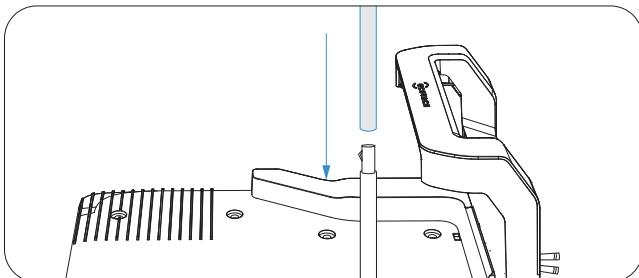
2. Inserire il piolo triangolare nel paletto di montaggio e serrarlo saldamente.
