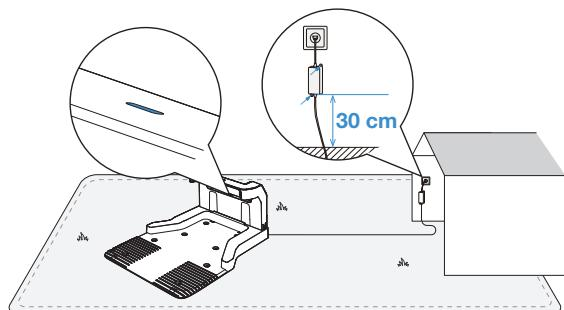
**Remarque :** Assurez-vous que l'adaptateur électrique est positionné 30 cm au-dessus du sol afin d'éviter tout dommage lié à l'eau ou l'humidité.
