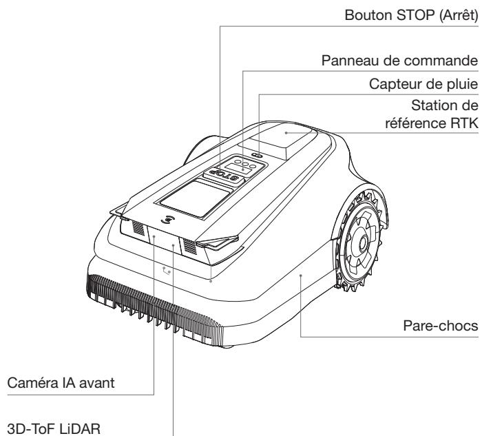
**Panneau de commande :** les boutons du panneau de commande peuvent être utilisés pour les opérations de base de la tondeuse. Les chiffres numériques sur l'écran du tableau de bord indiquent la progression de la tonte, le niveau de la batterie et l'état de la tondeuse.
