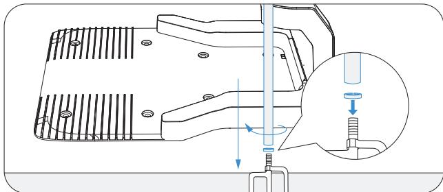
3. Fixez la tête de la balise en insérant sa partie surélevée dans le poteau de montage et en serrant les vis avec un outil.
