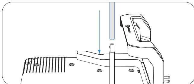
2. Insérez le piquet triangulaire dans le poteau de montage et fixez-le solidement.
