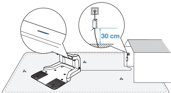
**Nota:** Posizionare l'adattatore di corrente a 30 cm da terra per evitare il contatto con acqua e umidità.
