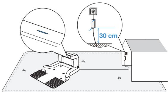
**Hinweis:** Bitte stellen Sie sicher, dass das Steckernetzteil 30 cm über dem Boden positioniert ist, um Schäden durch Wasser und Feuchtigkeit zu vermeiden.
