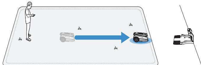
**Remarque :** Afin d'assurer la réussite du chargement, il est recommandé de garder la station de base à moins de 3 mètres de la pelouse, et à une distance maximale de 10 mètres.
