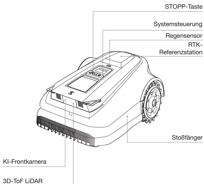
**Systemsteuerung:** Die Tasten auf der Systemsteuerung können für die grundlegenden Bedienfunktionen des Mähers verwendet werden. Die digitalen Zahlen auf dem Dashboard-Display zeigen den Mähfortschritt, den Akkustand und den Mäherstatus an.
