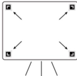
このウェブカメラは、2つのユニークなホワイトボードモードをサポートします。ホワイトボードモード（標準）では、ホワイトボードの四隅に認識マーカーを貼り付けます。ウェブカメラは、遠隔地の参加者がホワイトボードをより鮮明に見ることができるように、拡大表示します。このモードはジェスチャーや Controller ソフトウェアで有効にできます。スマートホワイトボードモードでは、認識マーカーを使わずに、ウェブカメラが自動的にホワイトボード領域を認識するか、Controller ソフトウェアを使って手動で設定します。
