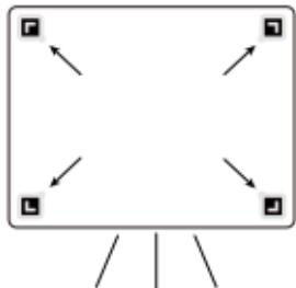
La webcam supporta due modalità di whiteboard. In Modalità Whiteboard (standard), posiziona un marker di riconoscimento in ogni angolo per delimitare l'area della whiteboard. La webcam migliorerà e ingrandirà l'area in modo che i partecipanti possano vedere la whiteboard più chiaramente.
