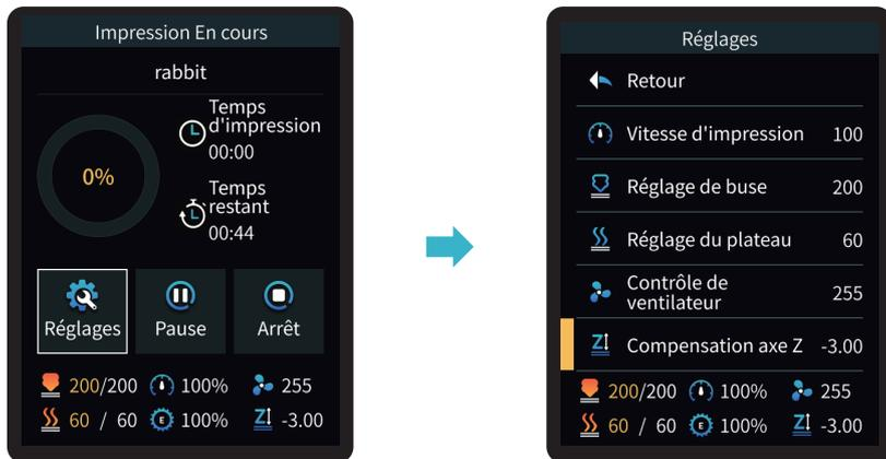
Pour l'effet de nivellement, veuillez vous référer à l'opération et essayez de maintenir une distance d'environ 0,1 mm entre la plate-forme d'impression et la buse.
